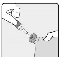
3 - Conecte o equipo de infusão da solução no disco de elastómero que lacra o contato da solução com o ambiente externo.
